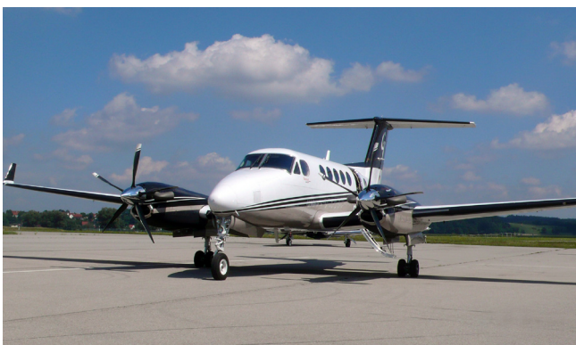
Von Beechcraft Augsburg umgerüstet: King Air B200GT mit 5-Blatt Propeller
