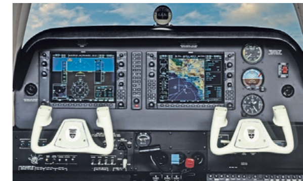
Mit dem G1000-Glascockpit von Garmin wird die Bonanza heute ausgeliefert
