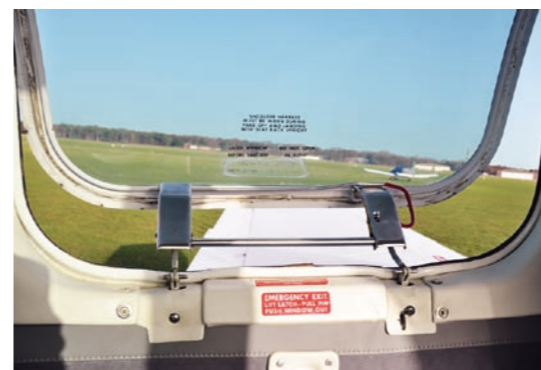
Die Ausstellfenster hinten liefern Frischluft am Boden – und sind Notausstieg
