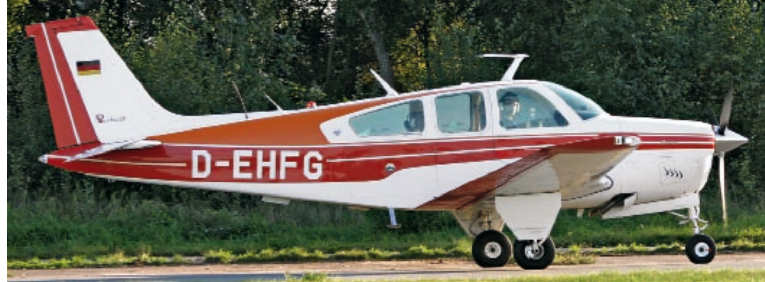
Massivbauweise: Das Fahrwerk der Bonanza (oben eine F33A) trägt auch die zweimotorige Beech Baron
