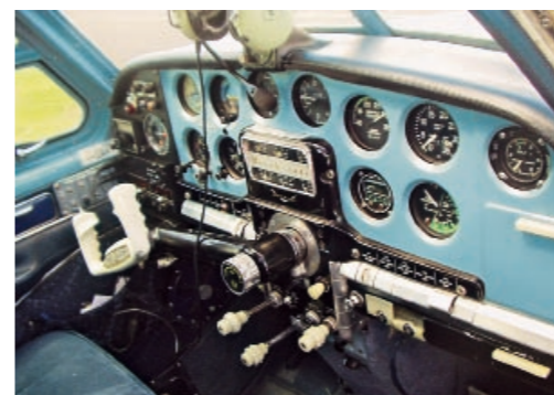
Ur-Panel mit einem Steuerhorn und »Piano-Tasten« in der Schalterleiste
